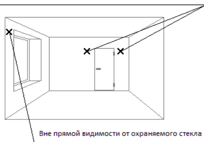
Рис. 3 Запрещенные места установки
