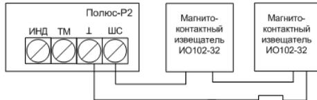
Рисунок 3.7 – Подключение внешних извещателей
