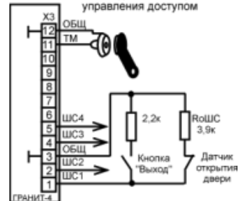
Рис 9. Подключение цепей управления доступом
